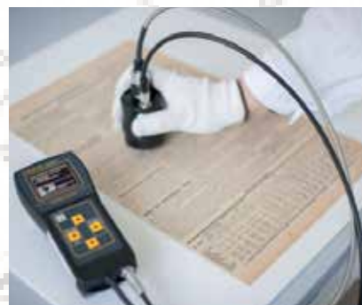
Mit Hilfe des Photo- spektrometers werden die analy- tischen Werte be- züglich Farbverän- derungen ermittelt.
